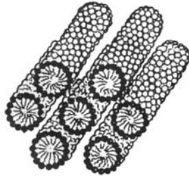
Figura 10. Corte transversal de la fase líquido cristalina hexagonal.
