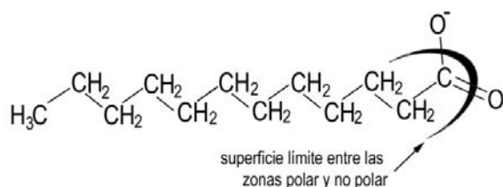
Figura 2. Límite entre las zonas polar y no polar de un jabón de acuerdo con Luzzati et al. 2 .
